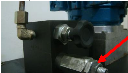
Vista da manopla a partir do lado esquerdo da central hidráulica. Veja a porca de ajuste mostrada pela seta.
